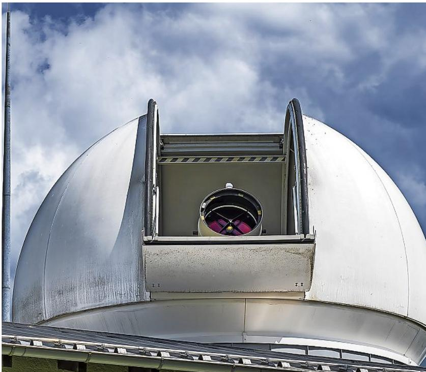
Ein Lasersystem zur Satellitenentfernungsmessung.
