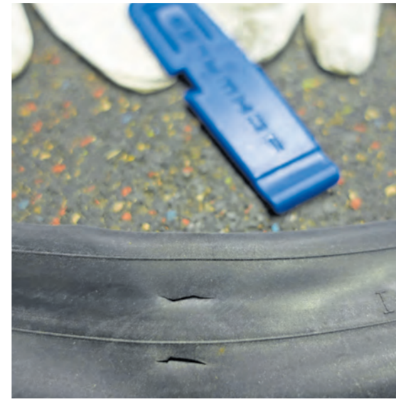
Ein „snake bite“ entsteht, wenn der Schlauch zwischen Felge und Reifenmantel eingeklemmt wird, zum Beispiel bei einem Aufprall. Foto: www.pd-f.de / Gunnar Fehlau
