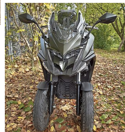
Schmal gebaut: Die Kymco-Neigetechnik sorgt für Fahrstabilität und Sicherheit. Foto: Huber
