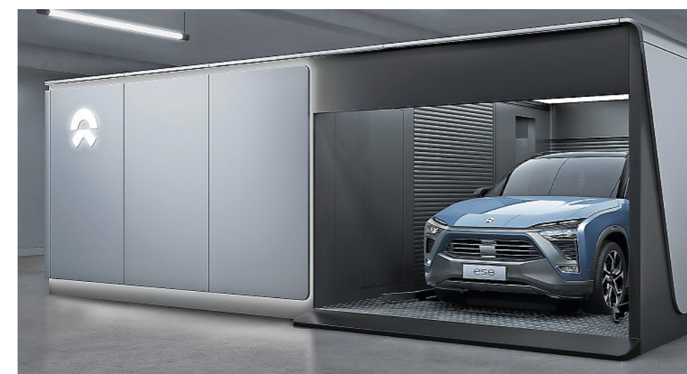
In den so genannten SWAP-Stationen werden Autos von Nio mit einem vollen Akku versorgt.
