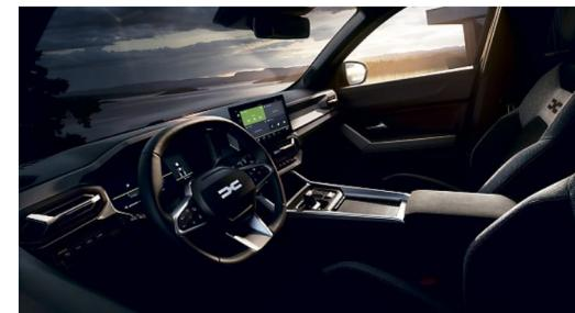
Zweimal zehn Zoll groß sind die Displays im Dacia Bigster. Nur die Basisvariante muss mit einem kleineren Tacho auskommen. Die Bedienung ist einfach, weil einfach logisch.
