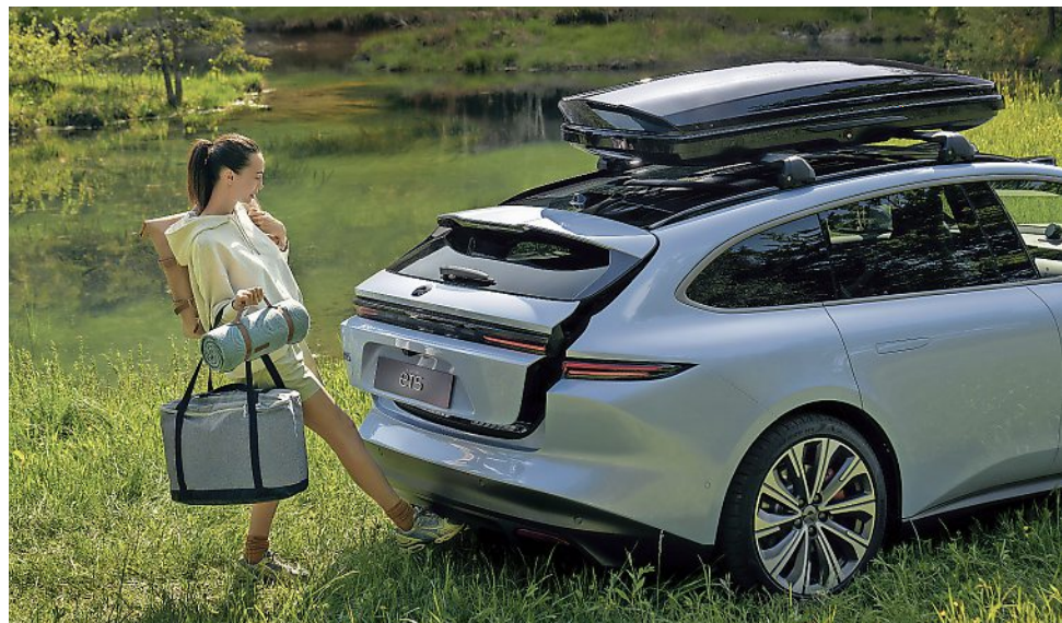
Ein (Luft-)Tritt unter das Heck genügt, und schon öffnet sich der Kofferraum des Nio ET5 Touring von selbst. Hilfreich, wenn man gerade alle Hände voll hat. Fotos: Nio
