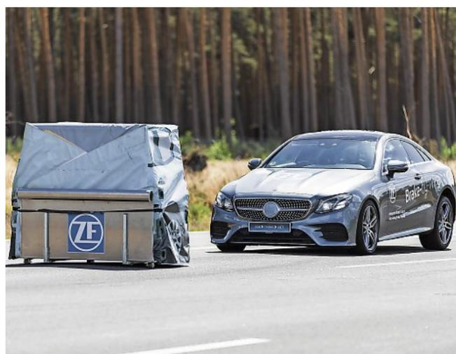
Ausweichmanöver mit der neuen Technik: Nach ausgiebigen Tests mit allen möglichen Gefahrensituationen ist klar, dass die entkoppelte Lenkung genauso gut funktioniert wie das analoge Vorbild. Foto und Grafik: ZF
