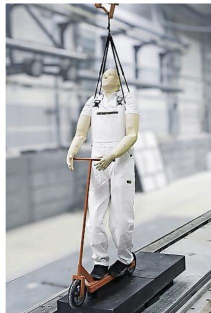
Im Crashtest wurden E-Scooter und Dummy mit 10, 20 und 30 Stundenkilometern frontal gegen eine Kante gesteuert.
