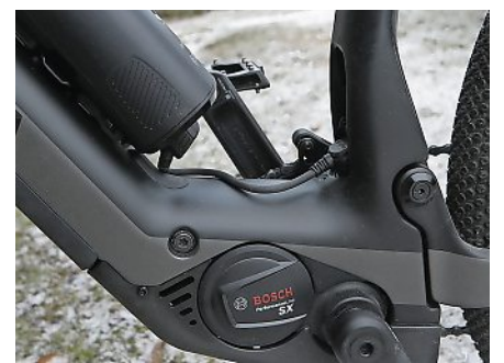
Der Gen5-Antrieb von Bosch bietet auch einen Zusatz-Akku für die Trinkflaschen-Halterung. Foto: Huber
