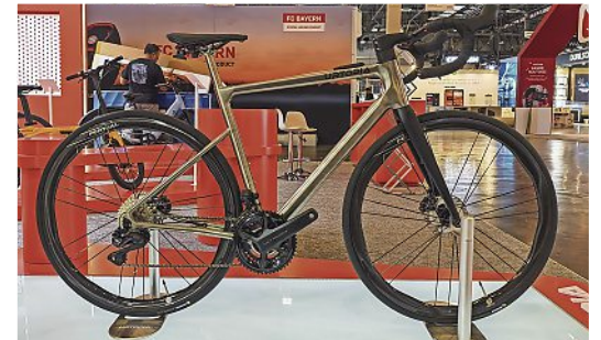
Das Urtopia Titanium Zero mit neuem 60-Nm-Antrieb wiegt nur zehn Kilo. Foto: Urtopia
