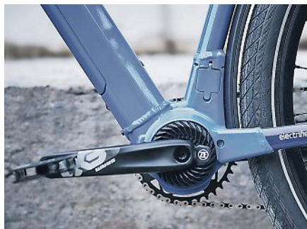
Der ZF-Mittelmotor namens Centrix ist extrem kompakt und kräftig. Foto: ZF
