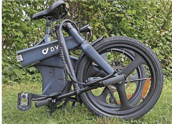
Bei Bedarf lässt sich das T1 blitzschnell in ein 850 x 480 x 780 Millimeter großes Paket falten.
