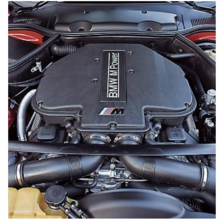
Fünf Liter Hubraum und 400 PS: Der Achtzylinder-Benziner des Z8 stammt aus dem BMW M5.
