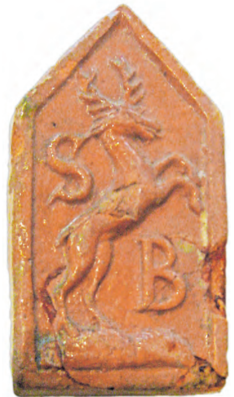
MARKSTEINZEUGEN, DIE VON FELDGESCHWORENEN ANGEBRACHT WERDEN, UM DIE INFORMATION ÜBER DIE LAGE EINES GESETZTEN GRENZSTEINS ZU „CODIEREN“, SIND IMMER NOCH USUS. ALLERDINGS SIND SIE HEUTE NICHT SO AUFWENDIG GESTALTET WIE DIESER VON ST. BLASIEN (LANDKREIS WALDSHUT).
