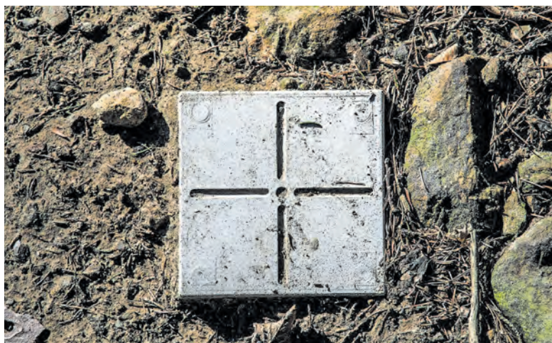
WENN IN BAYERN EIN GRUNDSTÜCK NEU VERMESSEN WIRD, WEIL GRENZMARKIERUNGEN FEHLEN ODER VERSCHOBEN SIND, IST ES DIE AUFGABE DER FELDGESCHWORENEN, NEUE GRENZPUNKTE ZU SETZEN.
