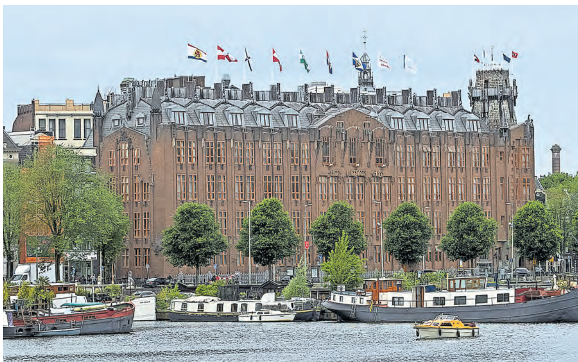
FÜR DIE FASSADE DES SCHEEPVAARTHUIS WURDEN VERSCHIEDENE ZIEGELARTEN UND ZAHLREICHE DEKORATIVE ELEMENTE VERWENDET. FOTO: W. SEIPP
