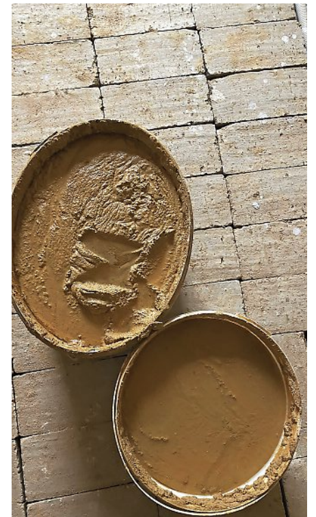
LEHMPUTZ KANN DIREKT AUF DIE WAND AUFGETRAGEN WERDEN.
