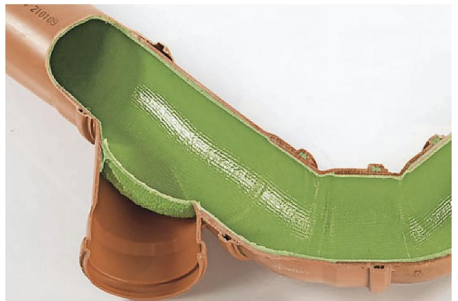
DAS ERGEBNIS BEIM SCHLAUCHLINING MIT EINEM HARZGETRÄNKTEM TEXTILSCHLAUCH LÄSST DEN URSPRÜNGLICHEN ZUSTAND DES AUSGEKLEIDETEN ROHRES NICHT EINMAL MEHR ERAHNEN, DENN DIE UNEBENHEITEN WERDEN GLÄTTEND ABGEDECKT. FOTO: BRAWO SYSTEMS
