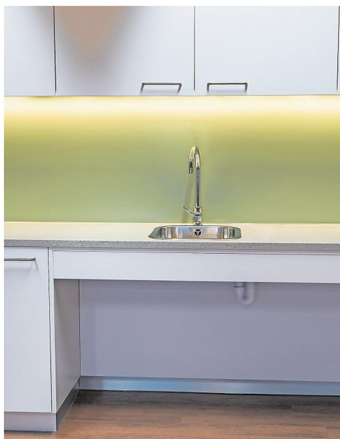
EIN UNTERFAHRBARER SPÜLBEREICH ERLEICHTERT ROLLSTUHLFAHRERINNE UND ROLLSTUHLFAHRERN DAS SELBSTSTÄNDIGE ARBEITEN IN DER KÜCHE. FOTO: ADOBE STOCK
