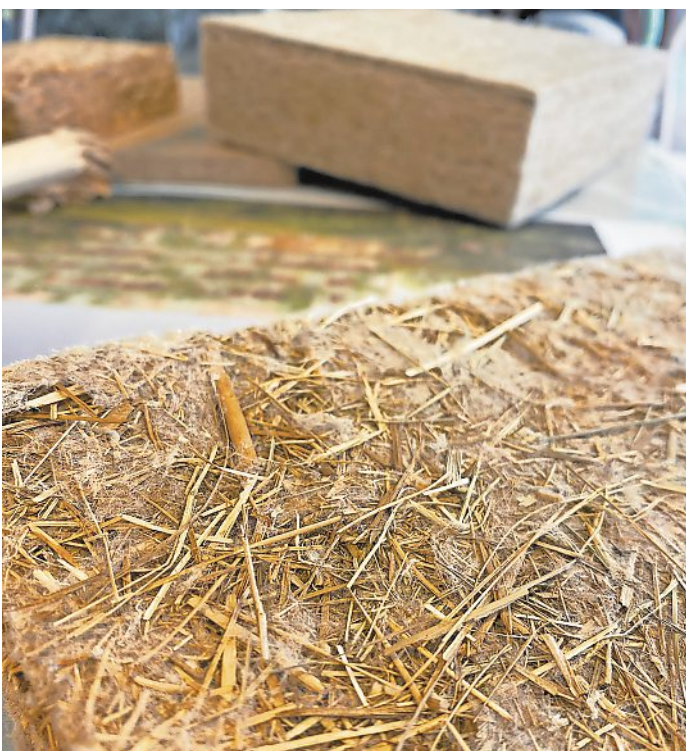
IN DÄMMUNG UND INNENAUSSTATTUNG KOMMEN PFLANZEN WIE DERVERNÄSSTER MOORE WIE ROHRKOLBEN, SCHILF UND FEUCHTWIESENGRÄSER ZUM EINSATZ. FOTO: MUNICH INNOVATION CREW
