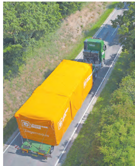
HIER „SCHWEBT“ EIN VORGEFERTIGTES ZIEGELMODUL AUF DIE BAUSTELLE.
