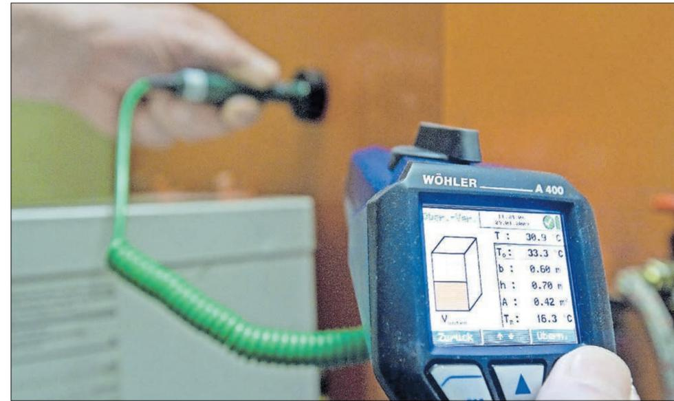
Zum Heizungs-Check gehört die Ermittlung der Oberflächenverluste am Kessel. Foto: ZVSHK
