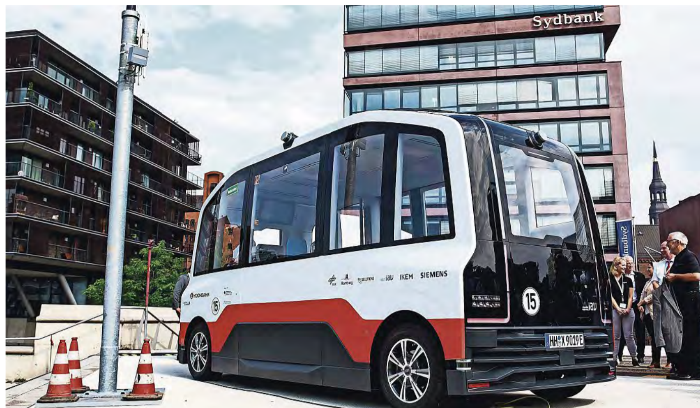
Ein autonom fahrender Elektro-Kleinbus der Hamburger Hochbahn neben einer Datensäule in der Hafencity: Ab August startet die Hamburger Hochbahn einen Testbetrieb mit Fahrgästen in fahrerlosen E-Kleinbussen in der Hafencity. Foto: dpa/Daniel Bockwoldt
