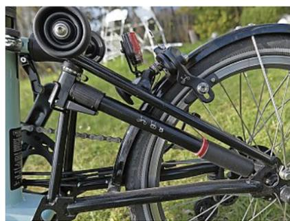
Pfiffig: Sogar eine Luftpumpe haben die Briten auf engstem Raum untergebracht.
