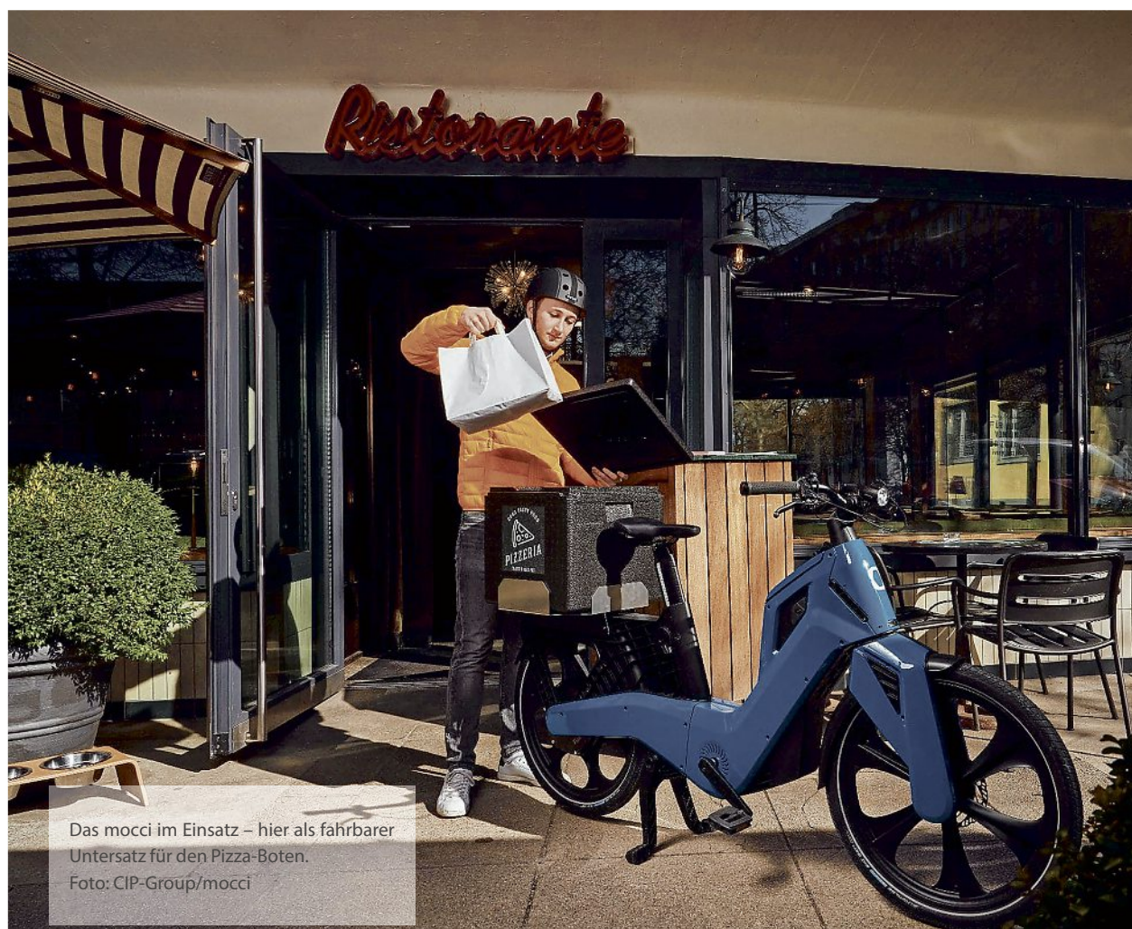
Recyclebar: Der Rahmen des mocci besteht aus einem gepressten Kunststoff-Teil. Foto: Huber
