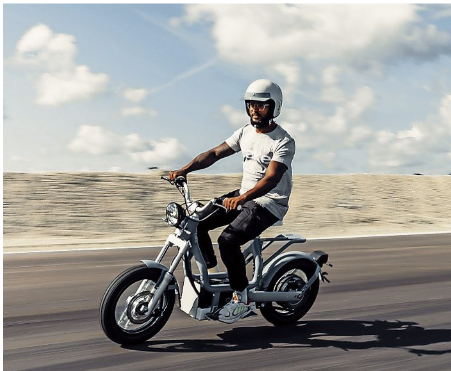
Das Cake Makka sieht halbwegs wie ein klassisches Mofa und Moped aus, ist entsprechend wahlweise auch 25 km/h oder 45 km/h schnell und besitzt einen Elektroantrieb. Foto: Cake
