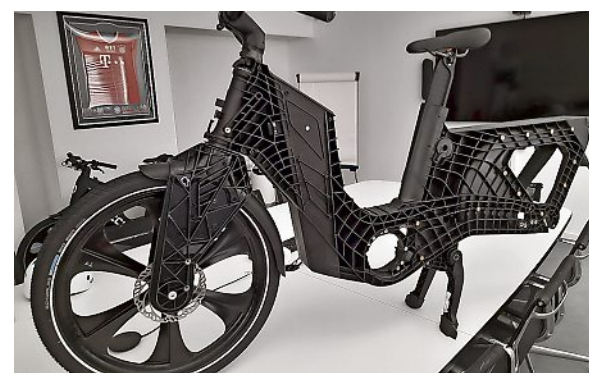
Recyclebar: Der Rahmen des mocci besteht aus einem gepressten Kunststoff-Teil. Foto: Huber
