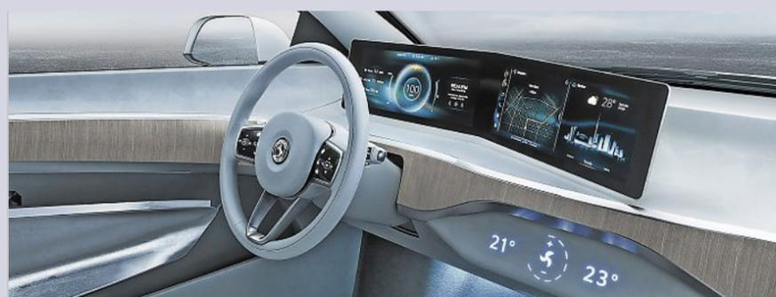
Durch die Anordnung des V-förmigen Displays werden nahezu alle Bildschirmhalte stets im gleichen Betrachtungsabstand angezeigt. Foto: Continental AG
