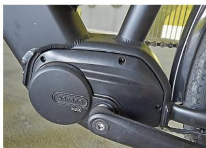
Sanfte Kraft: Der Bafang M200-Motor liefert ein Drehmoment von bis zu 65 Newtonmetern.
