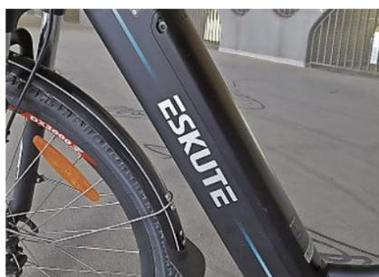
Stromspeicher: Der elegant integrierte Akku fasst 522 Wattstunden und sorgt für reichlich Reichweite.
