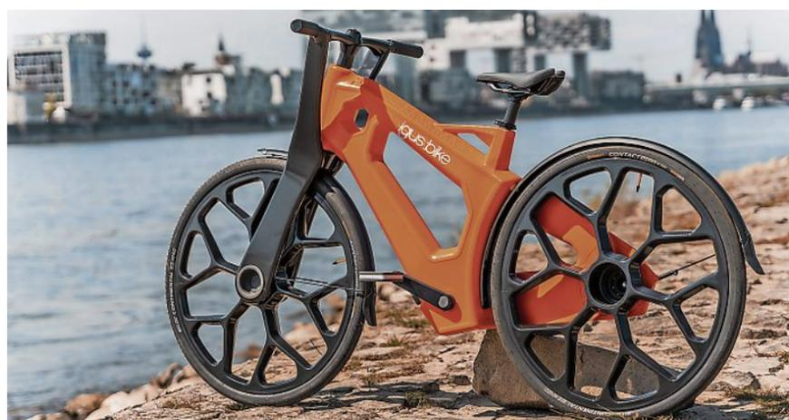
igus:bike ermöglicht eine wirklich nachhaltige Mobilität durch die Verwendung von recyceltem Kunststoff – nicht einmal Schmierstoffe werden mehr benötigt. Foto: igus:bike
