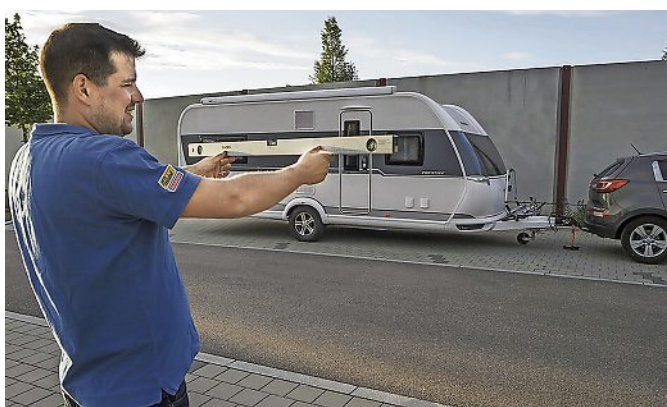
Bei der Ermittlung der Stützlast sollten Zugfahrzeug und Caravan immer in der Waage sein.
