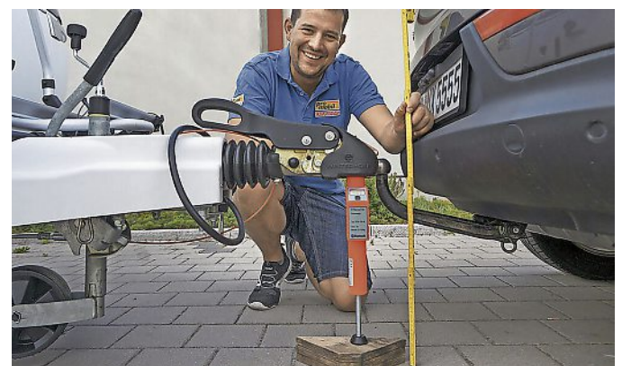
Waagen zur Ermittlung der tatsächlichen Stützlast gibt es im Zubehörhandel ab etwa 50 Euro. Fotos: caravaning.de
