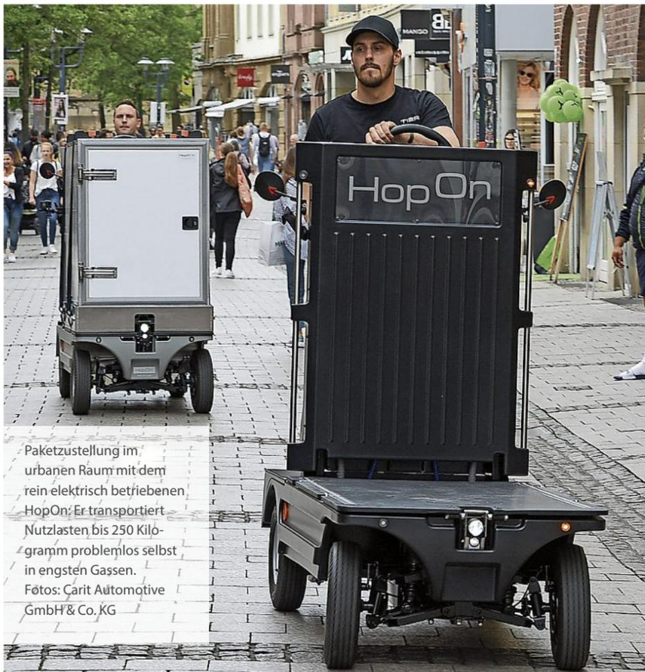
Paketzustellung im urbanen Raum mit dem rein elektrisch betriebenen HopOn: Er transportiert Nutzlasten bis 250 Kilogramm problemlos selbst in engsten Gassen.
