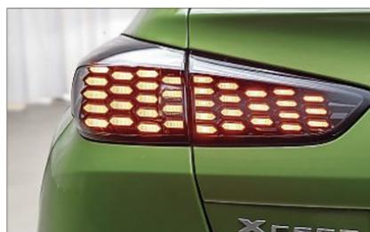
Wabenförmige LEDs stecken in den neuen Heckleuchten des Kia XCeed. Bei Benutzung formen Sie ein X. Fotos: Kia
