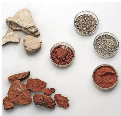
IM NEUEN BAUSTOFF 5TONS WURDE GROSSTEILS BAUSCHUTT VERWENDET.
