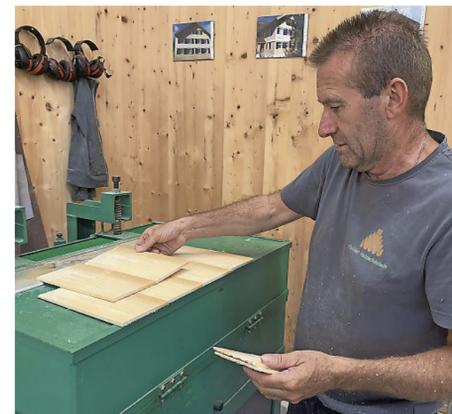
MILLIMETERGENAUE MASSARBEIT MIT EINEM NATÜRLICHEN WERKSTOFF: NACH DEM SPALTEN ÜBERPRÜFT MEISTER JOSEF FELDER DIE ABMESSUNGEN DER ROHLINGE.
