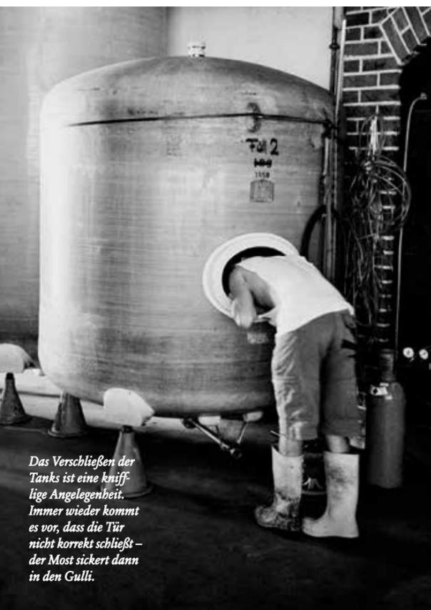
Das Verschließen der Tanks ist eine knifflige Angelegenheit. Immer wieder kommt es vor, dass die Tür nicht korrekt schließt – der Most sickert dann in den Gulli.
